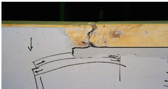
Fig. 3.10 Tensile failure due to a knot
