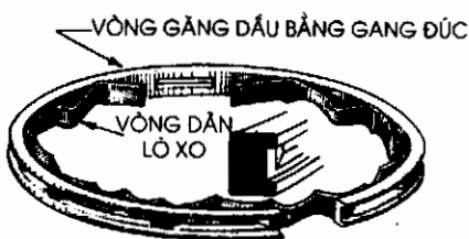
Hình 15. Vòng găng lò xo dẫn hai mảnh, thường dùng ở những động cơ đã sửa chữa, độ mòn của xi lanh nhiều.
