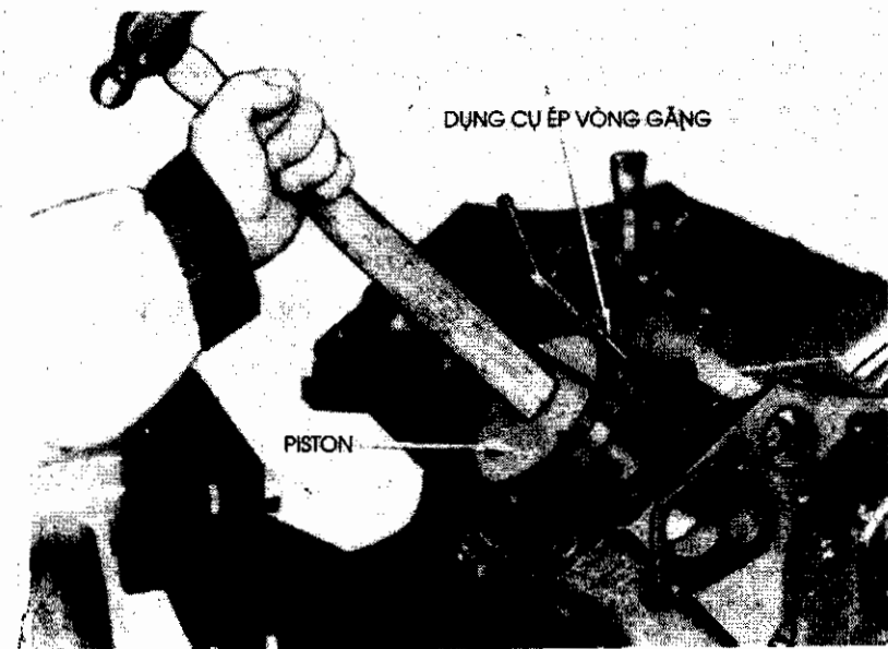
Hình 49. Dùng dụng cụ ép vòng găng để lắp cụm biên-piston vào ống xi lanh.
