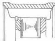
Hình 9-2. Cố định lõi sắt lên vỏ bằng gỗ và chốt
