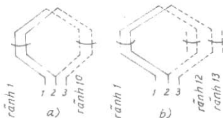
Hình 3-10. Sơ đồ nối dây thực tế của dây quấn sóng
