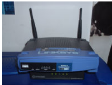
Hình 2-1: Thiết bị không dây điển hình: Wireless Access Point và card mạng không dây
