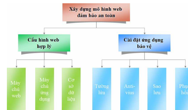
Hình 3.1. Xây dựng mô hình web đảm bảo an toàn
