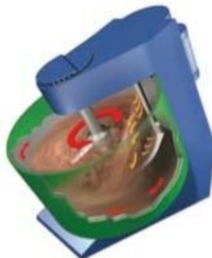
Hình 3: Máy trộn đối lưu cường độ cao loại R lần đầu tiên được làm ra năm 1972
