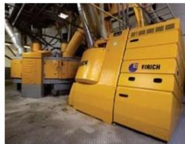
Hình 10: Tại Na Uy, các máy trộn kiểu hành tinh được thay thế bằng sản phẩm của Eirich do không đảm bảo chức năng làm tươi các cục nguyên liệu
