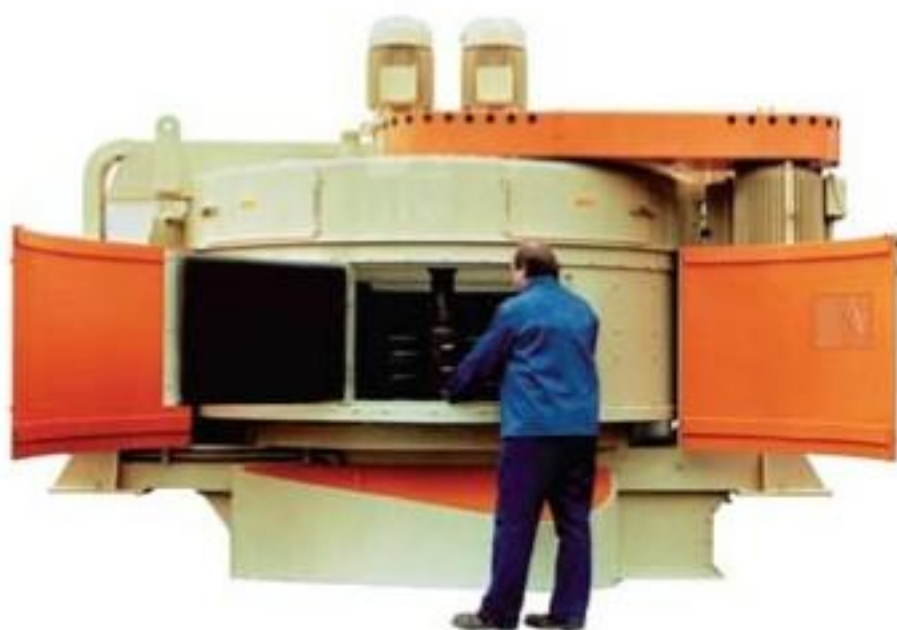
Hình 2: Máy trộn đối lưu cường độ cao với 1 trục trộn lần đầu tiên xuất hiện vào năm 1960, loại D
