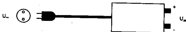
Hình 1.5. Bộ nguồn biến đổi điện áp xoay chiều thành một chiều
