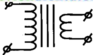
b) Biến áp lõi tôn Silíc
