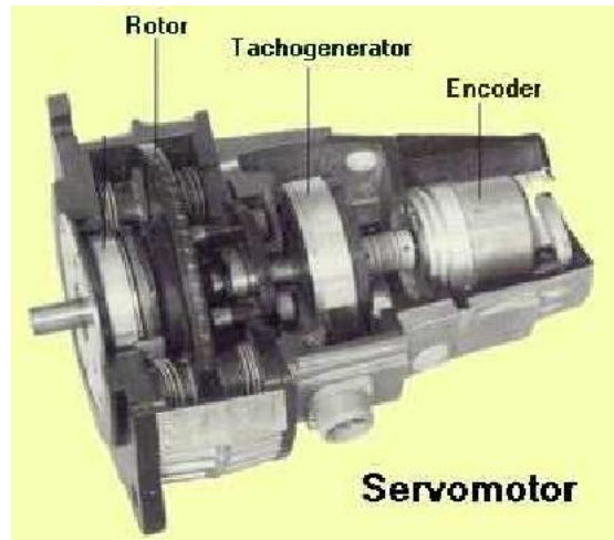
Hình 2.40 Cấu tạo servomoto
