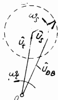
Hình 11.11. Đồ thị véc tơ của dao động điều chế đơn biên (có một phần dư của tải tin).
