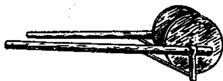
Hình 2-8. Giá đỡ bằng gỗ dùng để rải hoặc cuốn cuộn dây
