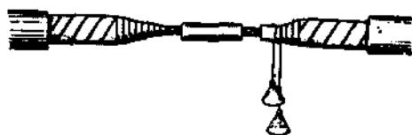
Hình 4-31. Bóc tách cách điện ruột cáp theo cấp 1. cách điện của ruột cáp; 2. ống lót nối; 3. dây thép gắn quả chặn bằng chì.
