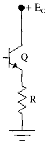
Hình 1.11. Cách cấp điện cho cực Emitter dùng R
