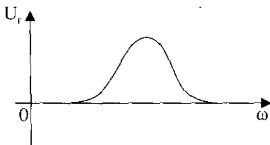
Hình 3.11. Đặc tuyến tần số mạch lọc thông dải
