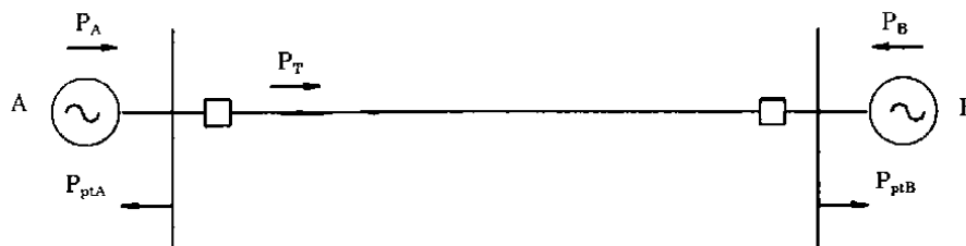
Hình 1.15. Cân bằng công suất tác dụng trong hệ thống điện (bỏ qua tổn thất):
