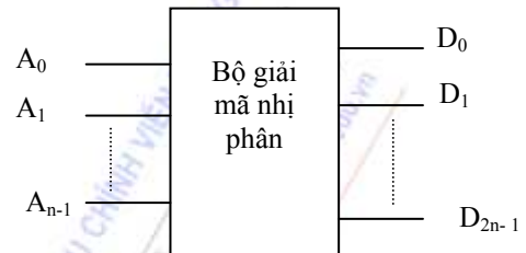
Hình 3-13. Sơ đồ khối của bộ giải mã nhị phân
