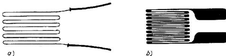
Hình 2.18 Điện trở Tenzô : a) dạng dây; b) dạng lưới màng
