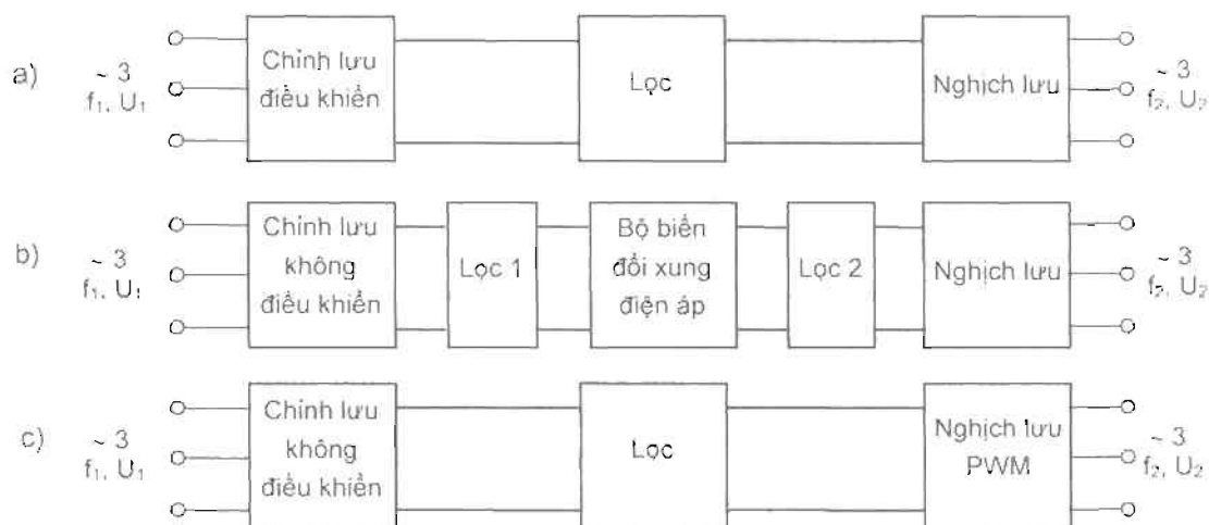
Hình 8.4. Bộ biến tần gián tiếp có khâu trung gian một chiều
